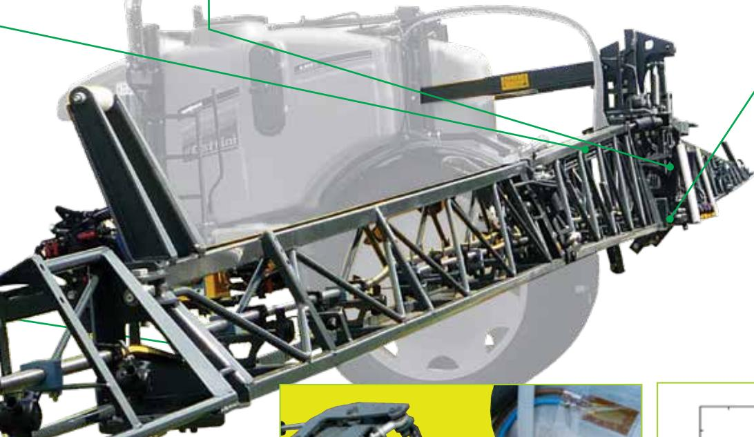
Die innovativen mehrschichtigen Pleuelgestängedämpfer (HBL-Gestänge) garantieren eine gute Dämpfung gegen die vertikale Schwingung.
